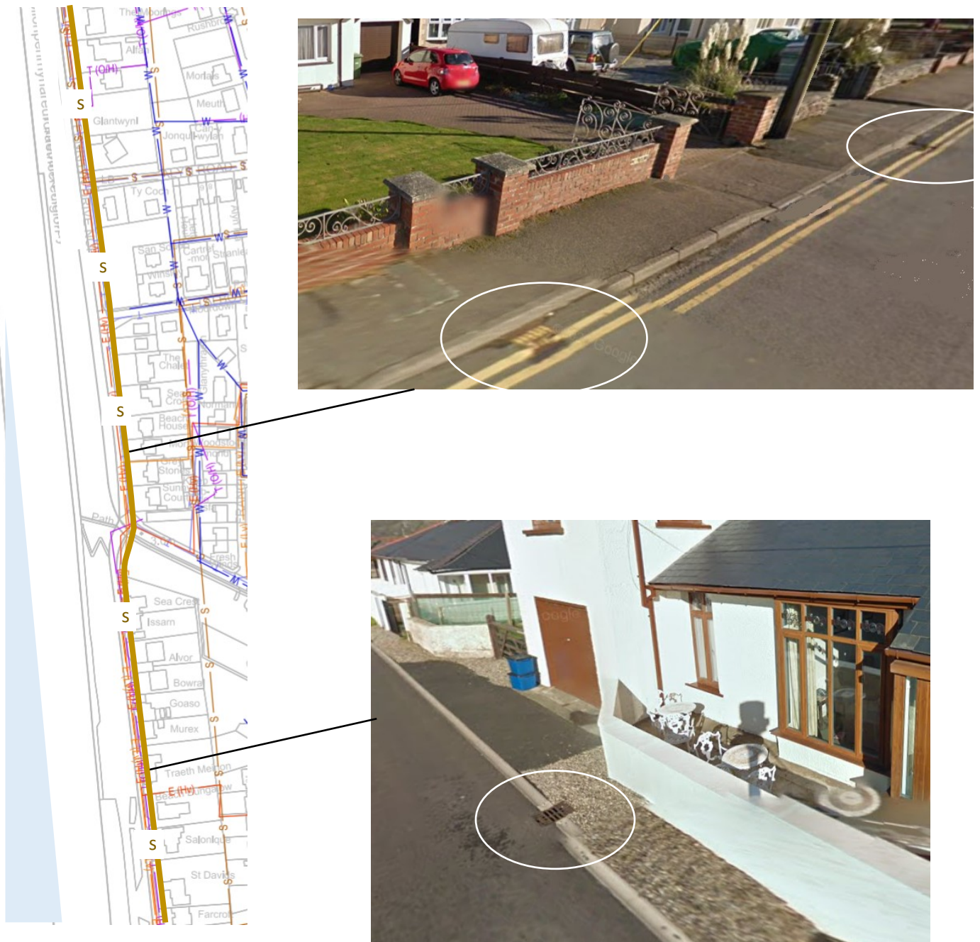
Ffigur 35: (chwith) Map cyfleustodau yn dangos lleoliad carthffos gladdedig ar hyd Penrhyn Drive (ar ôl Black and Veatch, 2012). (dde) Gridiau draenio ymyl ffordd o flaen eiddo yn Penrhyn Drive.
